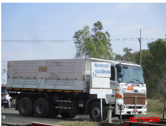
รูปที่ 2-15 การปิดคลุมผ้าใบรถบรรทุก และป้ายเตือนให้ปิดคลุมผ้าใบ
